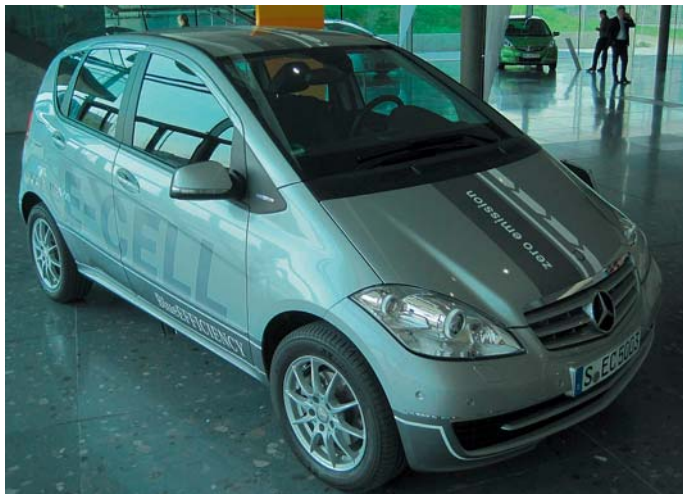
Daimler stellte den Mercedes A-Klasse E-Cell aus, eine fünfsitzige Limousine mit Vorderradantrieb, 50 kW permanenterregter Synchron Motor und einer zusätzlichen Lithium-Ionen Batterie von 36 kWh
