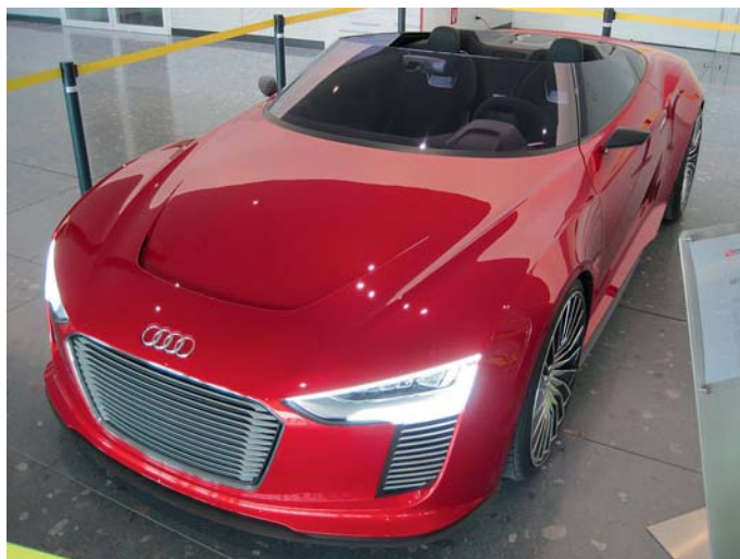
Audi E-Tron Spyder, zweisitziges Cabrio, Allradantrieb, zwei Synchron-elektromotoren mit zusammen 88 kW plus ein 3Liter Sechszylinder V Motor mit 221 kW
