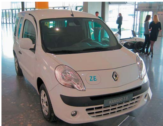
Renault Kangoo Z.E. – zweisitziger Van, Hinterradantrieb, permanenterregter Synchron-Motor mit 44 kW, Lithium-Ionen Akku, max. 130 km/h, Reichweite bis 160 km
